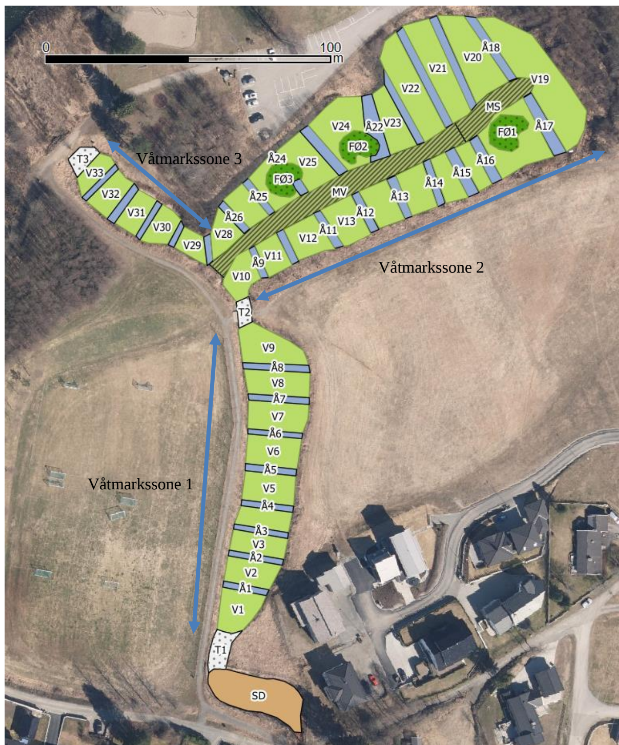
Figur 2. Renseparkens oppbygning med sedimentasjonsdam (SD), terskler (T1-T3) og 3 våtmarksfilter som igjen er inndelt i vegetasjonssoner (V1-V33), åpne soner (Å1-Å31) og fugleøyer (FØ1-FØ3). En vegg (MV og MS) går mellom våtmarksfilter 2.
