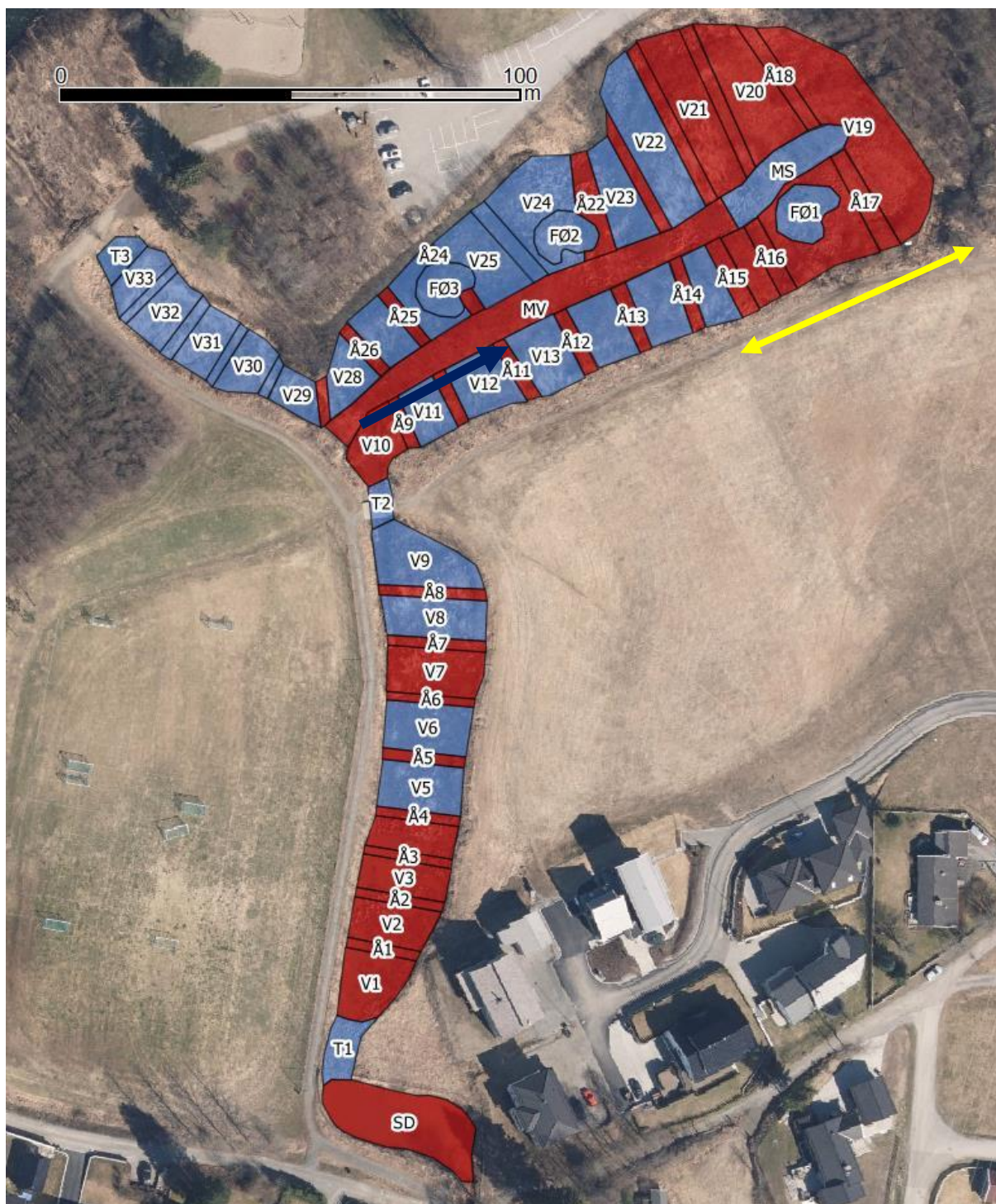
Figur 6. Dammens soner som har behov for vedlikehold er merket rødt. Østre del av våtmarksfilter 2 (gul pil) bør prioriteres i forbedringen av våtmarksfiltrene. Blå pil symboliserer dypål.
